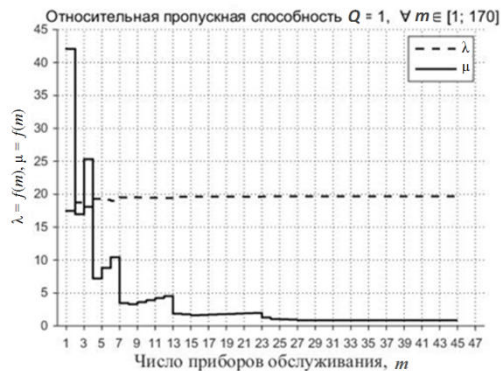
Рис. 1. Оптимальные зависимости параметров СМО типа M/M/m/170
