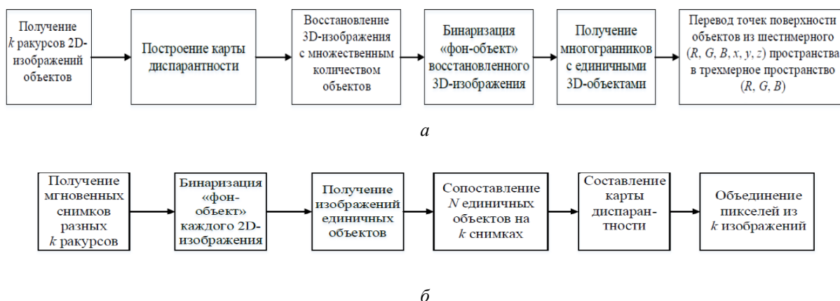
Рис. 2. Блок-схема восстановления информации о 3D-поверхности по набору 2D-изображений разного ракурса:
