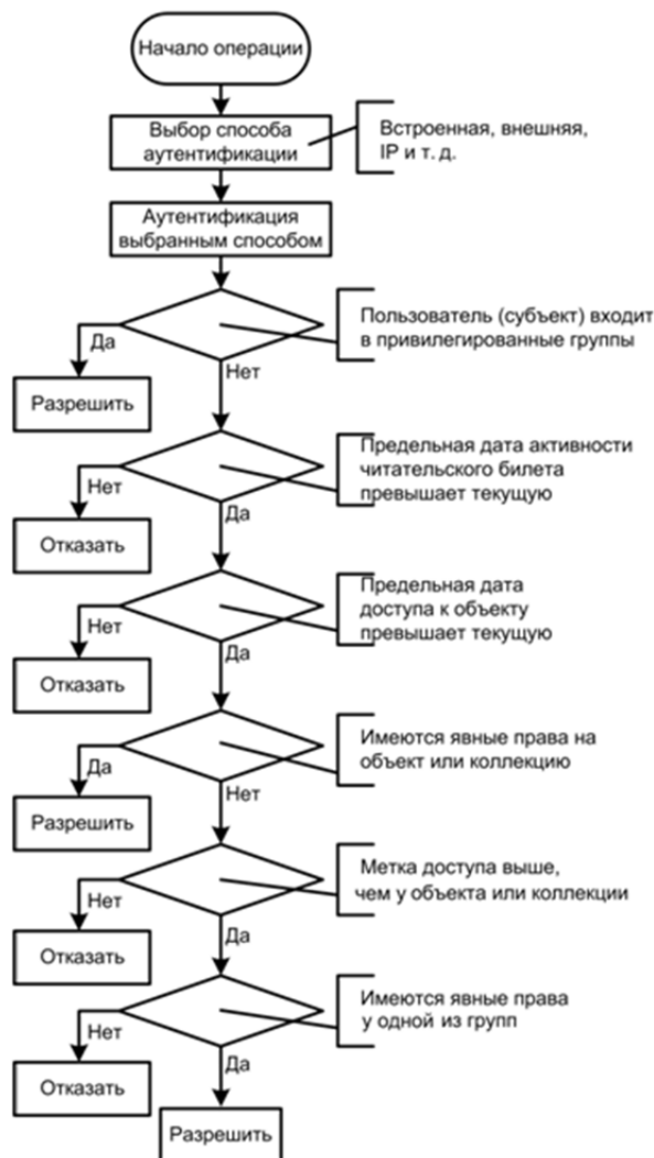
Рис. 1. Блок-схема расширенной проверки прав пользователя на выполнение операции
