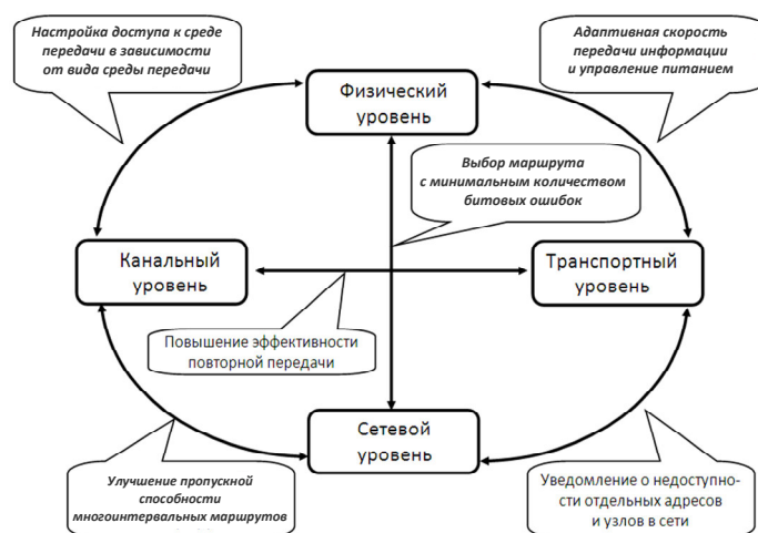
Рис. 3. Пример взаимодействия уровней модели OSI 7
